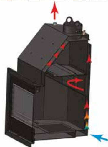
Esquema de circulación del agua. Water circulating diagram. Esquema de circulação da água.
